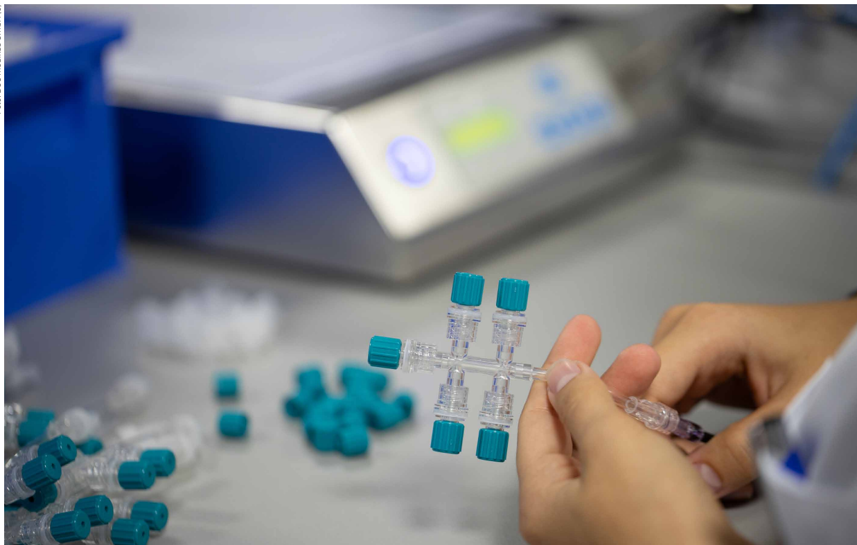
Fertigung komplexer Infusionssysteme im Reinraum
